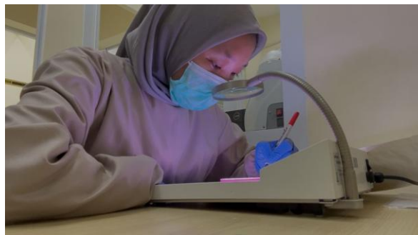
Gambar 6. Proses Perhitungan Koloni Menggunakan Colony Counter
